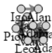
Rysunek 6.12. Układ sieci przy domyślnym ustawieniu charge . Węzły są skupione zbyt blisko siebie, by były czytelne
